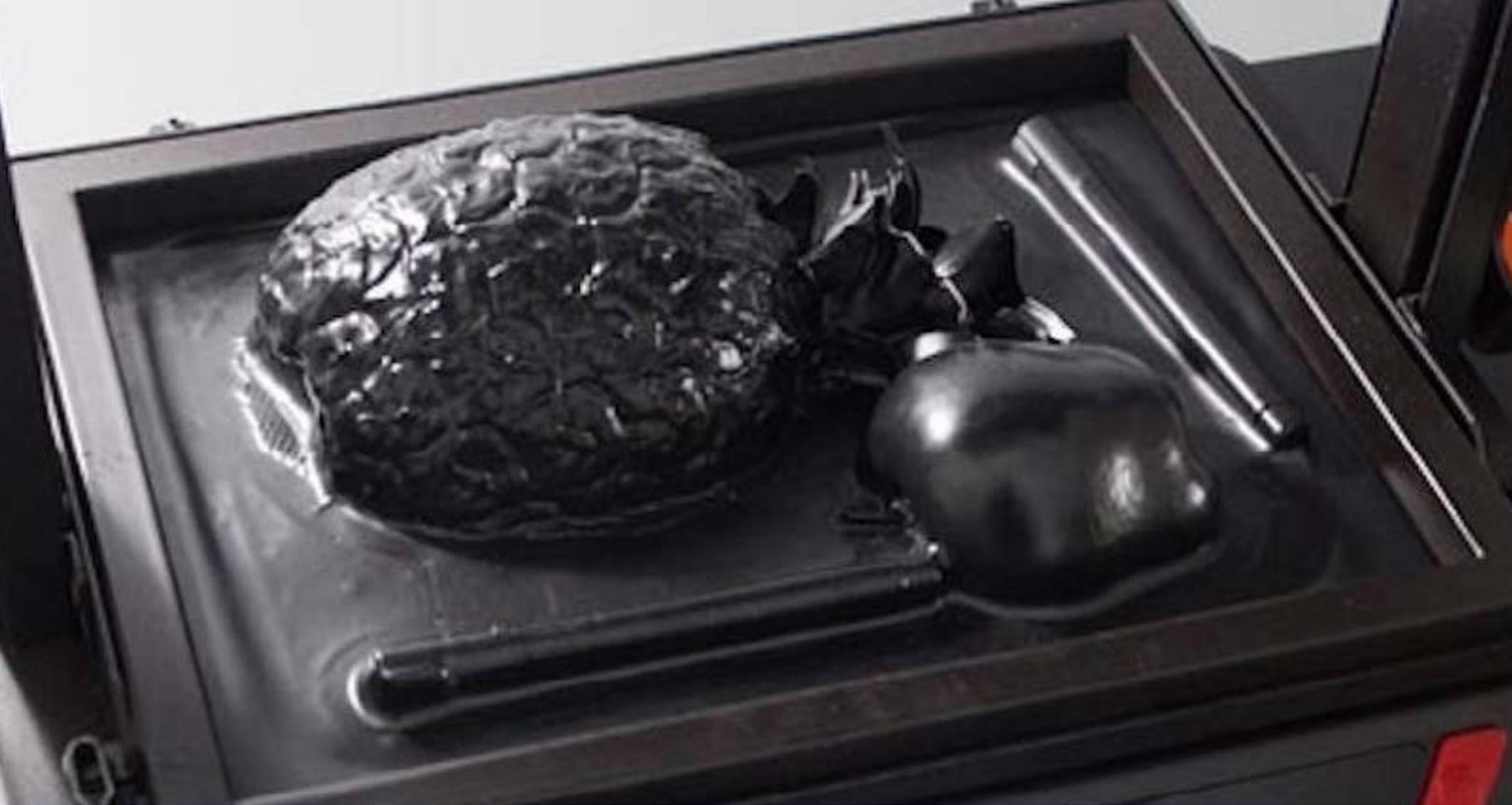
**No passado, as peças produzidas por vacuum forming necessitavam de um processo adicional, denominado operação de corte. Isto é, após moldadas, algumas peças precisavam ser “cortadas” no tamanho final em equipamentos manuais.**
