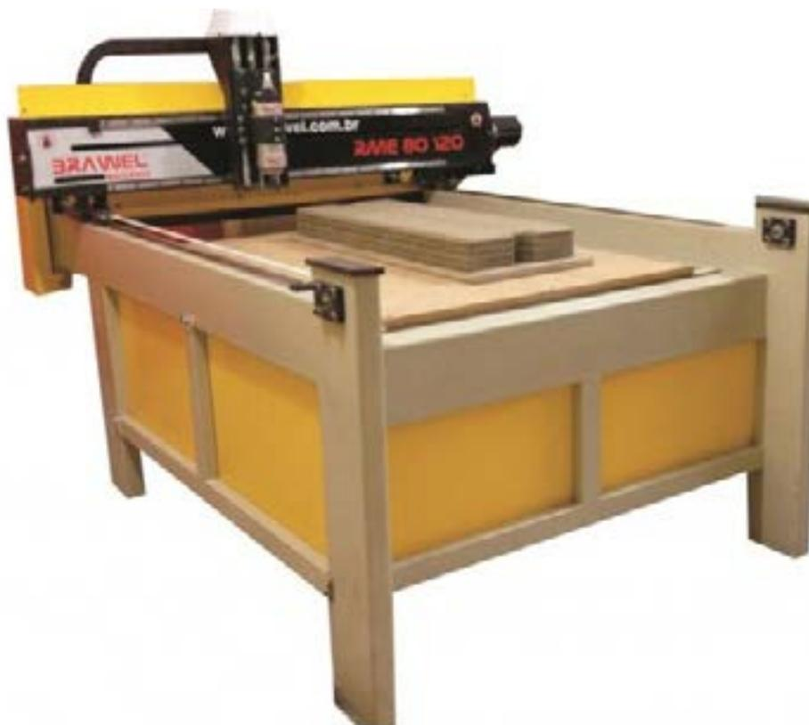
Com a popularização dos Routers CNC, por conta dos custos mais acessíveis, além de a máquina fazer a operação de corte, ela pode também efetuar furos, rasgos, rebaixos, roscas e outros detalhes nas peças de forma rápida e precisa, eliminando a mão de obra e trabalhos manuais.
