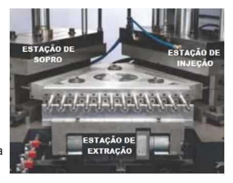
Quando ocorre o giro da mesa, os machos contendo as pré-formas são posicionadas precisamente dentro do molde de sopro, onde recebem pressão do ar devidamente programada, ocorrendo ou não a biorientação.
