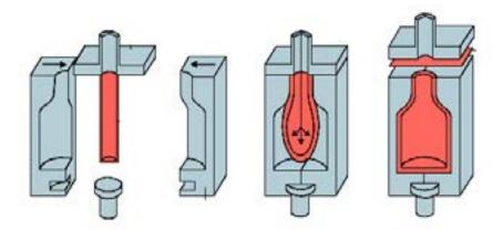
Consequentemente, o parison se expande, dando forma ao produto conforme a cavidade do molde.
