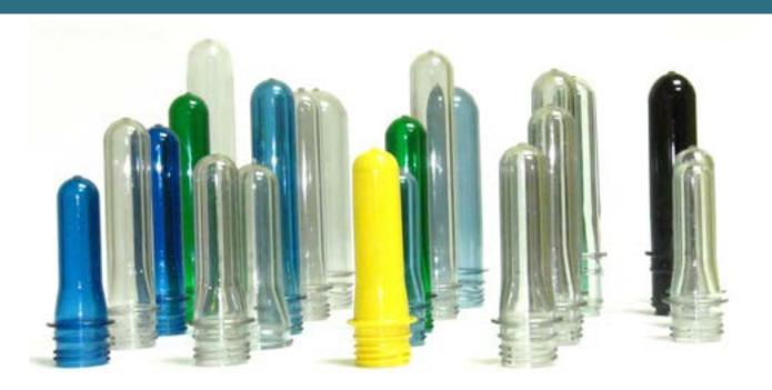
o caso das técnicas IBM e ISBM, ambas necessitam da formação de pré-formas, porque a resina PET possui uma viscosidade baixa que não permite sua utilização no sopro convencional; só no caso do PETG (polietileno tereftalato glicol), que possui viscosidade mais elevada, capaz de permitir a formação do parison, isso seria possível porém, como apresenta custo muito elevado em relação ao PET convencional, acaba não sendo viável o sua aplicação.
